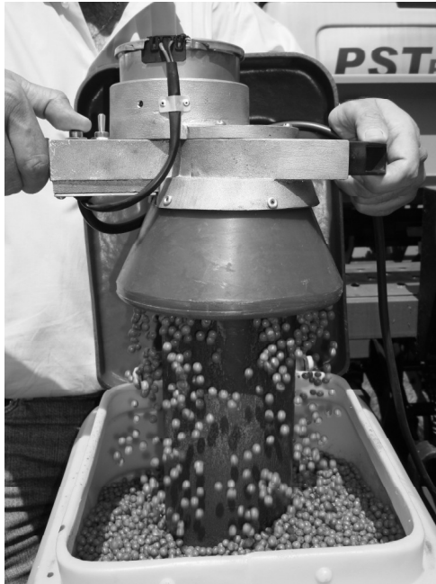
FIGURAS 4 e 5. Máquinas de tratar sementes diretamente na caixa da semeadora. (Fotos: A.A. Henning)
